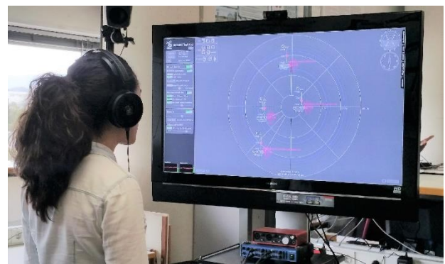
Figura 6: El 3D Tune-In Toolkit es una librería de renderizado de audio 3D binaural y simulación de pérdida auditiva y audífonos.
