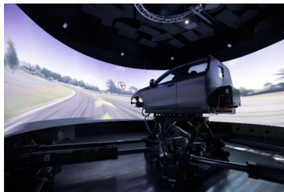
Figura 4. Simulador de conducción DIM250
