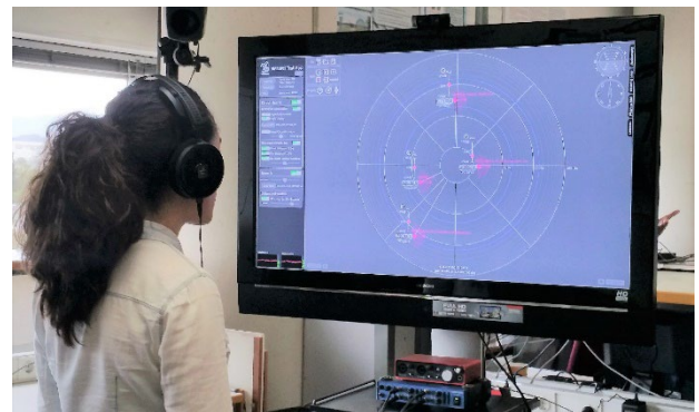
Figura 6: El 3D Tune-In Toolkit es una librería de renderizado de audio 3D binaural y simulación de pérdida auditiva y audífonos.
