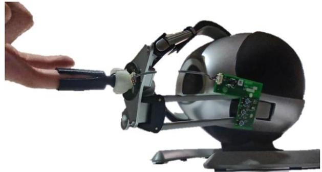
Figura 11: End-effector con forma de dedal conectado al Falcon.
