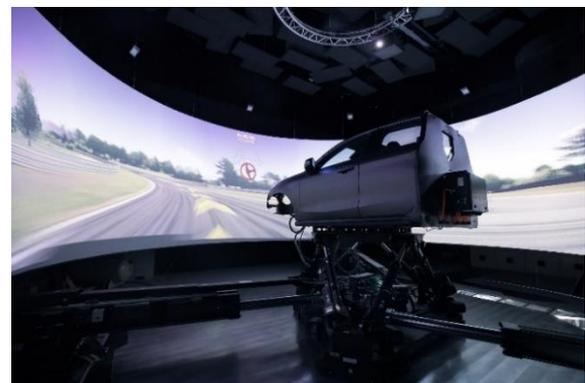
Figura 4. Simulador de conducción DIM250
